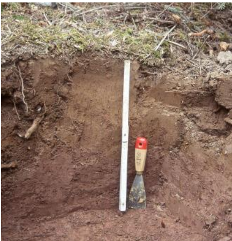
Flach entwickelte Braunerde auf Tonstein der Rötton-Formation östlich von Freudenstadt (Begleitboden in b4 )
