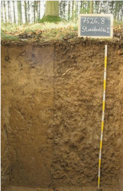
Parabraunerde aus mehrschichtigem Lösslehm (jüngerer, locker gelagerter Lösslehm, ab 70 cm u. Fl. auf älterem dichter gelagertem Lösslehm) – Ulmer Alb (p119)
