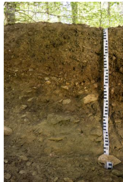
Mittel tief entwickelte Terra fusca-Parabraunerde aus geringmächtiger lösslehmhaltiger Fließerde über Moränensediment mit hohem Gehalt an Kalksteinen des Oberjuras (U61)
