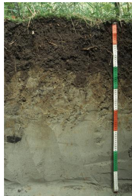
Gley aus schluffig-sandigem Seesediment im Schussenbecken (U129)
