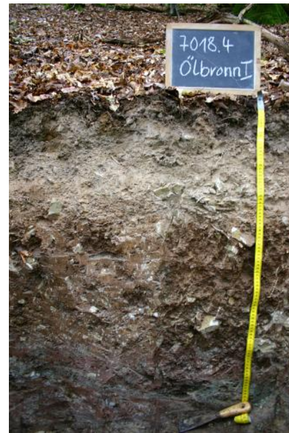
Pelosol-Braunerde aus Fließerden über Tonstein des Gipskeupers (Grabfeld-Formation)
