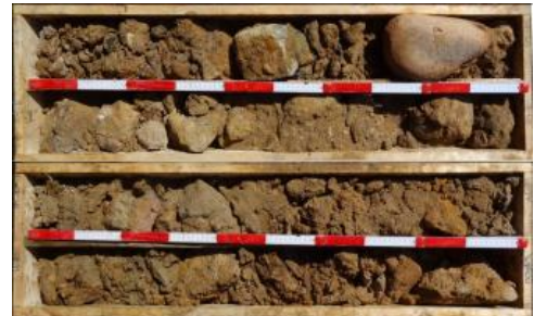
Stark verwitterter bis entfestigter Schotter der Wasser-Subformation in einer Bohrung aus Freiburg i. Br. – Die Gerölle bestehen überwiegend aus Gneis und Granit lokaler Herkunft (Schwarzwald).
