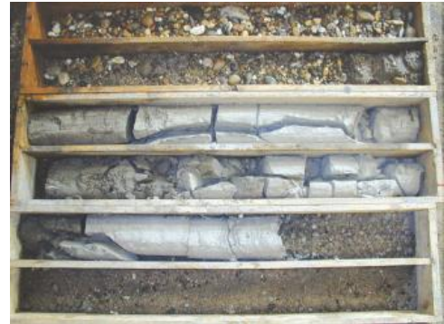
Die Ludwigshafen-Formation (graues Feinsediment) in der Bohrung BK 1A Hauf, darüber die Mannheim-Formation, darunter die Viernheim-Formation
