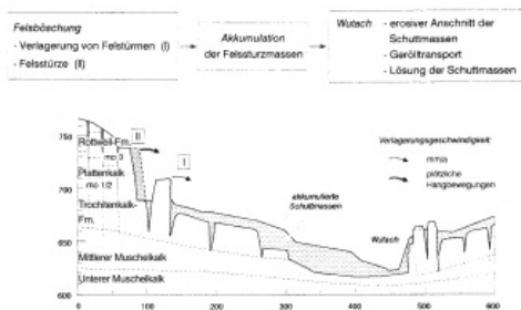
Schematische, 1,5-fach überhöhte Darstellung der Massenbewegungen im Übergangsbereich Mittlerer Muschelkalk–Oberer Muschelkalk (Grafik: Jordan, 1993)
