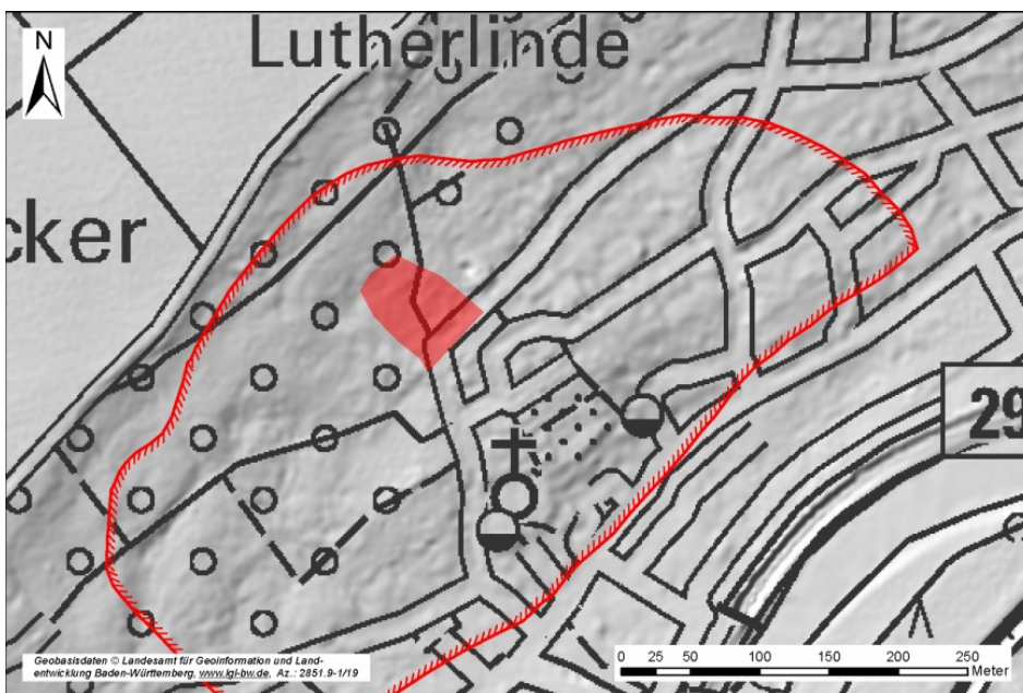
Übersichtsgrafik zum ungefähren Umriss der Hangrutschung (rote Fläche) mit Eintrag der Hinweisflächen auf Rutschungen nach Ingenieurgeologischer Gefahrenhinweiskarte von Baden-Württemberg (IGHK50, rot umrandete Fläche)
