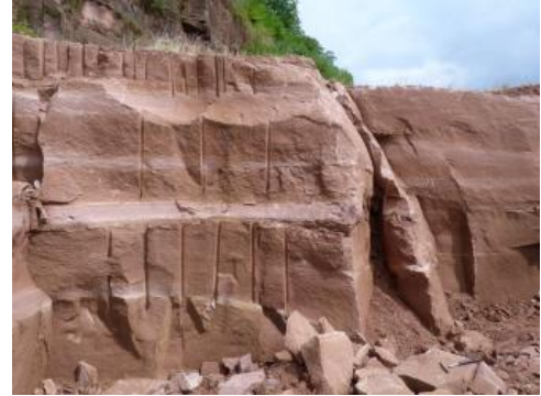
Steinbruch zur Gewinnung von Werksteinblöcken (Hartsandstein)
