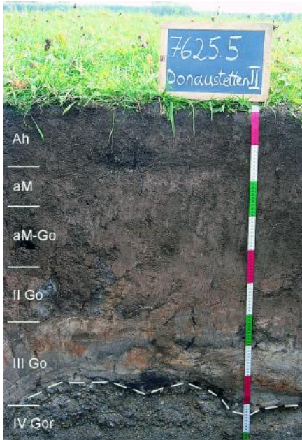
Kalkreicher Brauner Auenboden-Auengley aus Auenlehm über Auensand und sandigem Hochflutsediment auf Donauschotter
