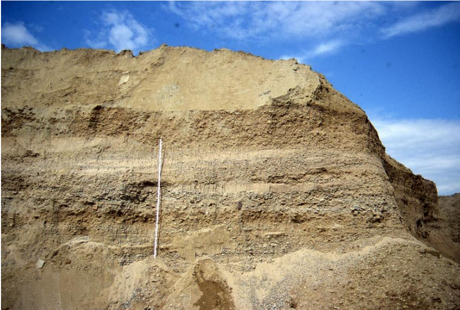
Abbauwand mit Kies- und Sandlagen des Neckars (Länge der Messlatte 3 m).
