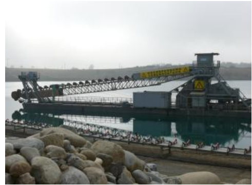
Eimerkettenbagger in einem Baggersee
