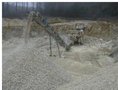
Kies und Sand werden maschinell abgegraben, der Kalkstein wird auch gesprengt.
