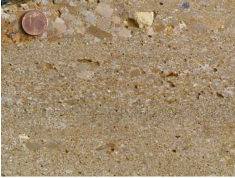
Kalksandstein aus Britzingen mit hohem Anteil an kantigen Bruchstücken in Fein- und Mittelkiesgröße
