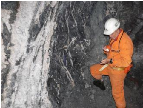
Fahlerzreicher Schwerspatgang in der Grube Clara
