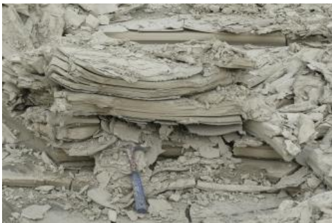
Infolge von Austrocknung aufgeblätterte Bändertone (Beckensediment der Hasenweiler-Formation) in der Tongrube Herdwangen-Schönach-Großschönach
