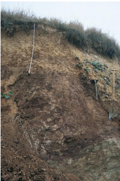
Lösslehm und verwitterter Tonmergelstein der Grabfeld-Formation
