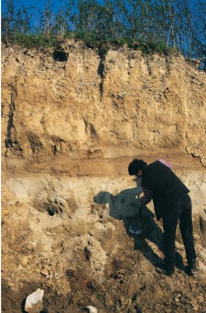
Feinkörnige Lockergesteine aus lösslehmreicher Fließerde und unterlagernden risszeitlichen Seesedimenten
