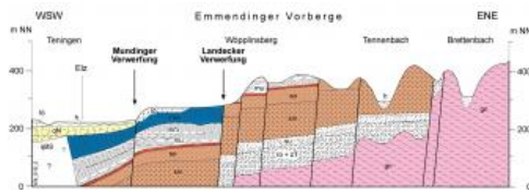
Geologischer Schnitt durch die südliche Lahr-Emmendinger Vorbergzone
