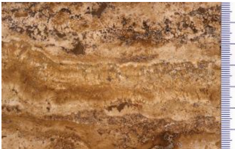
Sauerwasserkalk mit lagenweisem Wechsel von stark kavernösem und dichtem Sinterkalk
