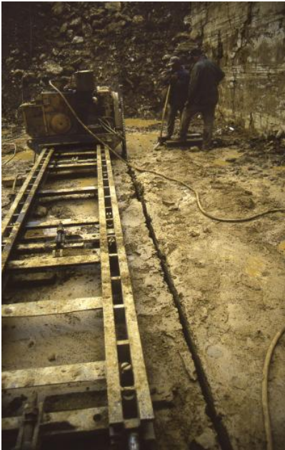
Abbau mit der Schwertsäge im Travertinsteinbruch Lauster
