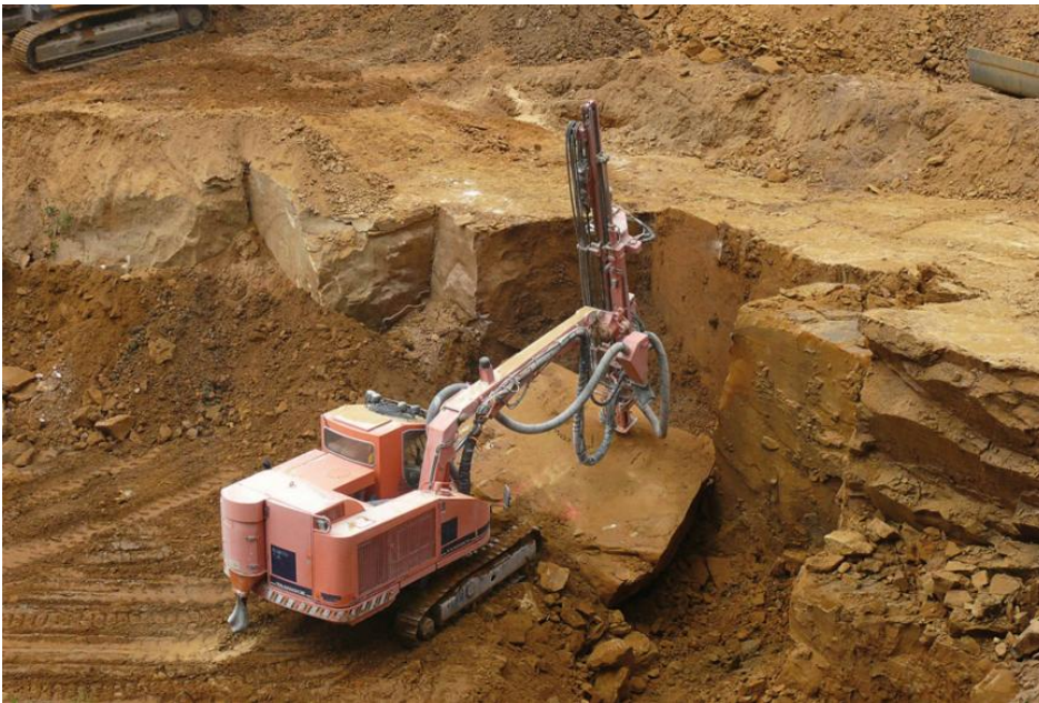
Ablösung der Blöcke (Eisensandstein-Vorkommen der Banzenmühle bei Lauchheim)
