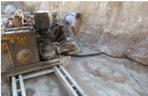
Abbau mit Schrämsäge, Steinbruch Gauingen
