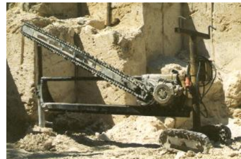
Kalktuffabbau der Fa. Beck bei Bärenthal: Schwertsäge zum Kalktuffabbau
