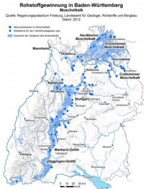
Austrich des Muschelkalks in Baden-Württemberg mit Lage der in Betrieb befindlichen Abbaustellen (Stand 02/2013)
