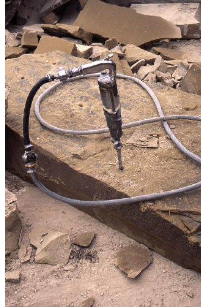
Verarbeitung der dickplattigen Sandsteine zu Mauersteinen, Gemeindesteinbruch Mühlbach
