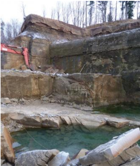
Dickbankige Werksteinzone im Gemeindesteinbruch Mühlbach
