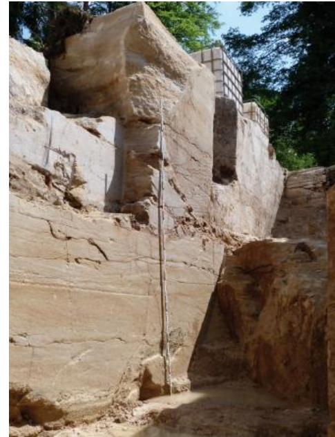
4 m tiefer Probeabbau im Waldgebiet Oberer Neubronn
