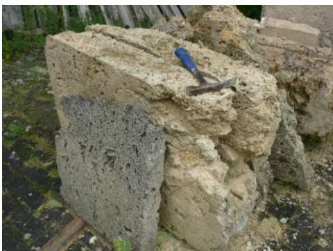
Gesägte Kalktuffplatten im Steinbruch Bärenthal
