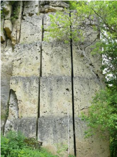
Kalktuffwand mit Abbauspuren durch eine Schrämsäge
