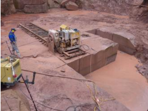
Gewinnung großformatiger, fester Sandsteinblöcke im Steinbruch Tennenbach
