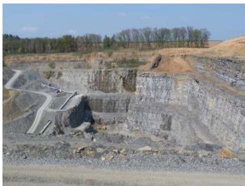
Kesselabbau in der Meißner- und Trochitenkalk-Formation des Oberen Muschelkalks im Steinbruch Ittlingen mit mächtiger Überlagerung aus Sedimenten des Keupers
