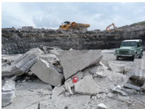
Lockerungssprengung im Böhrlingen-Sulfat
