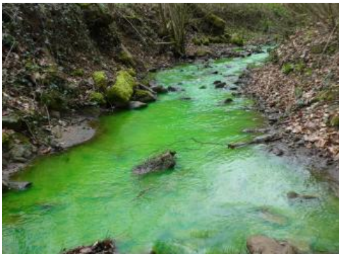
Mit dem Markierungsstoff Uranin eingefärbtes Oberflächengewässer
