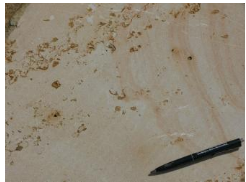
Detailaufnahme einer gesägten Sandsteinoberfläche mit Toneinschlüssen und Limonitverfärbungen.
