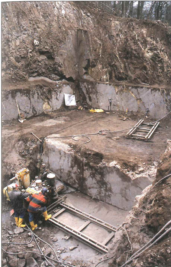
Abb. 13: Abbau von Tephrit-Pyroklastit am Schlossberg bei Achkarren mit der Schwertsäge, Herstellen der 3. Sohle im Febr. 2004.
