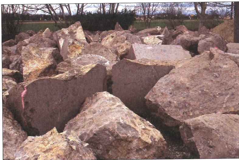
Abb. 16: Ausgewählte Werksteinblöcke im Lager bei Breisach; von den insgesamt gelösten ca. 570 m 3 wurden 130 m 3 zur Bearbeitung durch die Steinmetzfirmen ausgewählt und ins Zwischenlager gebracht.
